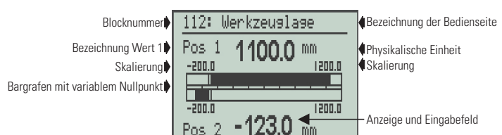
Fig. 6 Bargraph-Anzeige horizontal (VBAR)
